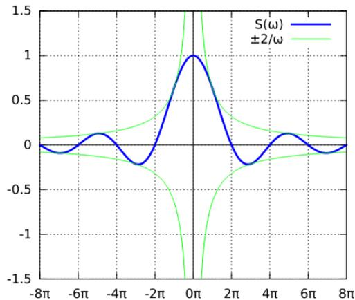
1. ábra. Az  $s(x)$  egységnyi négyszögimpulzus és  $S(\omega) = \frac{2}{\omega} \sin(\frac{\omega}{2})$  Fourier-transzformáltja.
